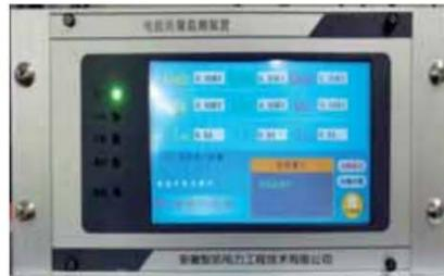
电能质量监测装置集保护、测量、监视、控制、人机接口、通信等多种功能于一体；具有先进内核结构、高速运算能力和实时信号处理等优良特性，是对电网运行质量进行监测及分析的专用产品，可以提供电力运行中的电压、电流、三相不平衡、功率、电能及谐波监测等故障数据分析，并配备了大容量的存储器，能够对电网运行进行长时期的数据采集监测。
